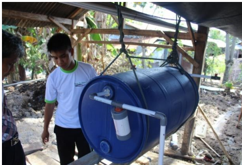
Gambar 3. Instalasi biogas yang dibangun bersama mahasiswa
