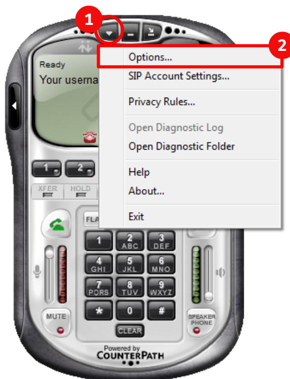
Gambar 4.2. Konfigurasi opsi pemilihan CoDec softphone X-Lite
